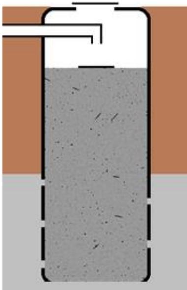
Ces équipements sont des modes de rejets des eaux usées traitées. Le but est d'infiltrer les eaux usées dans le sous-sol.
